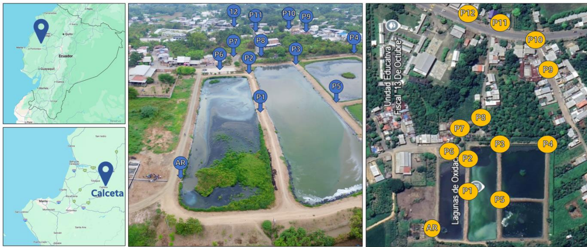
Figura 1. Mapa de ubicación con 12 puntos de monitoreo en laguna de oxidación del cantón Calceta, Manabí. Donde AR = Ingreso de agua residual doméstica.
