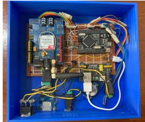
Figura 6. Acoplamiento de módulos del proyecto
