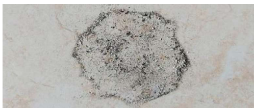
Figura 11. Desprendimiento de zinc MIG
