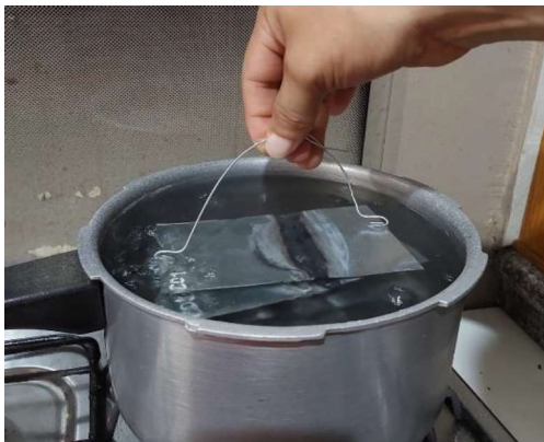
Figura 4. Sumersión de cupones en solución salina
