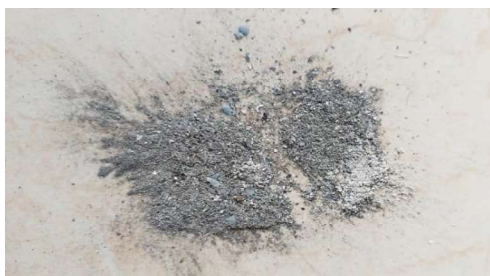
Figura 10. Desprendimiento de zinc oxiacetilénica
