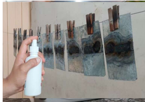
Figura 5. Atomización de cupones cada hora con solución salina
