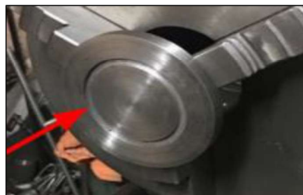
Figura 4. Canal donde se coloca sello de alta temperatura.
