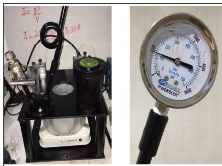
Figura 15. Reactor cargado, se observa la presión de 110 bar en el manómetro.
