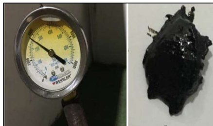
Figura 16. En la izquierda se observa que el manómetro alcanza 250 bar o 3700 psi, a la derecha biopetróleo obtenido.
