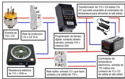
Figura 10. Instalación eléctrica de controlador tiempo y temperatura.
