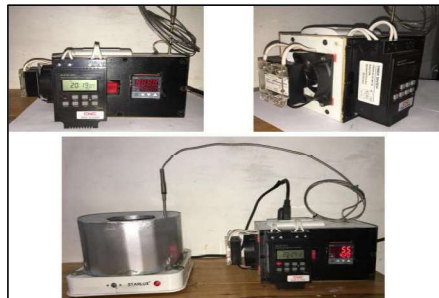
Figura 12. Controlador de tiempo, de temperatura y sensor de calor, junto al calentador eléctrico.
