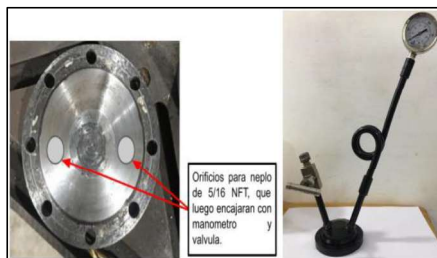
Figura 3. Tapa del reactor de alta presión.
