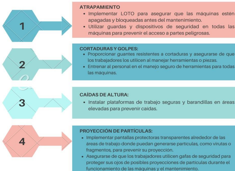
Figura 6: Medidas preventivas para riesgos mecánicos en el mantenimiento de máquinas de mecanizado convencional
