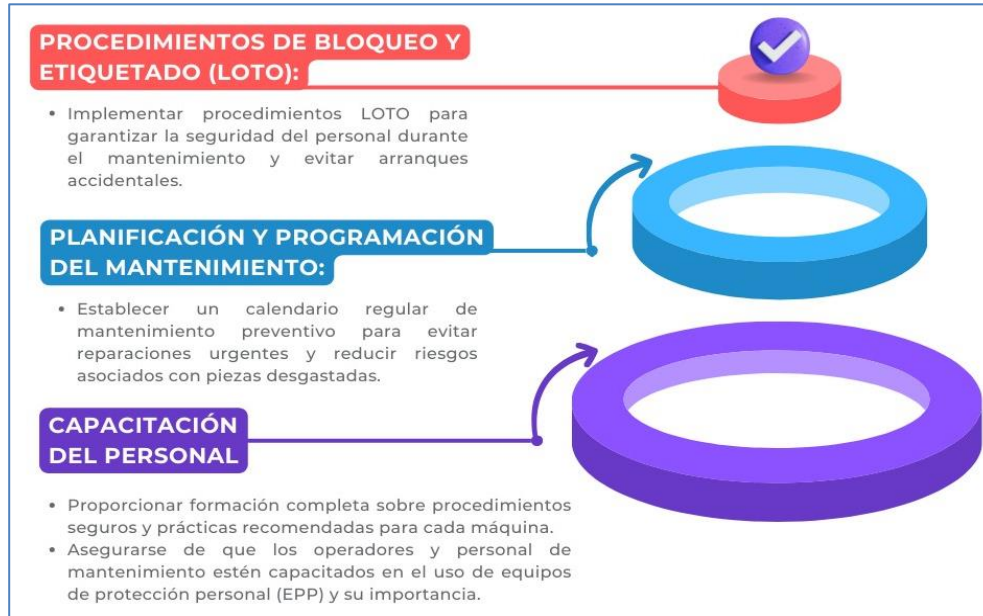
Figura 5: Medidas preventivas generales a implementar en el mantenimiento de máquinas de mecanizado convencional
