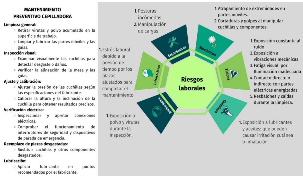
Figura 3: Riesgos laborales en las tareas de mantenimiento preventivo de la cepilladora
