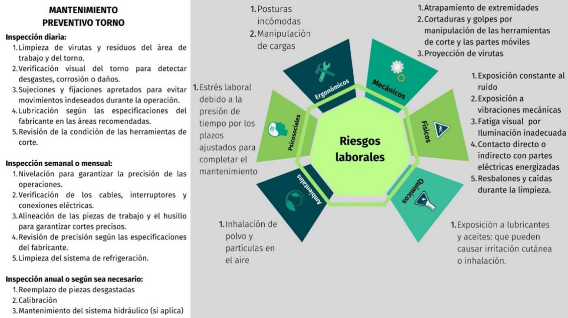
Figura 2: Riesgos laborales en las tareas de mantenimiento preventivo del torno
