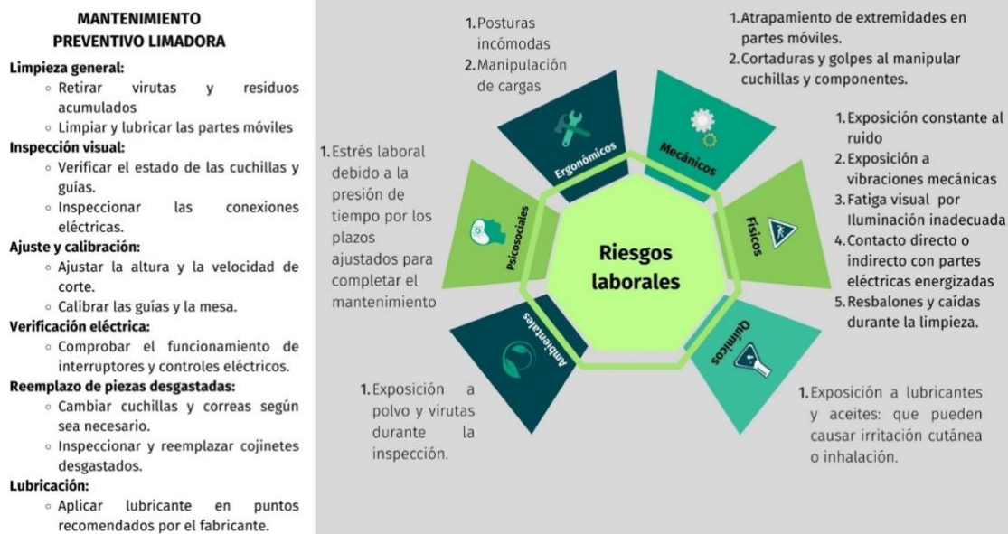
Figura 4: Riesgos laborales en las tareas de mantenimiento preventivo de la limadora.
