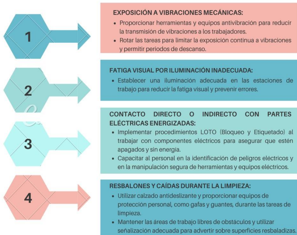
Figura 7: Medidas preventivas para riesgos físicos en el mantenimiento de máquinas de mecanizado convencional
