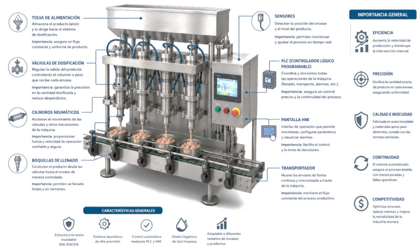
Figura 2. Componentes principales de una máquina llenadora utilizada en la industria atunera.
