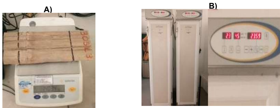
Figura 6. Acondicionamiento previo al ensayo de reacción al fuego (ISO 11925-2): (A) registro de masa inicial de las probetas; (B) acondicionamiento en cámara climática hasta alcanzar masa constante de acuerdo con norma ISO 11925-2.
