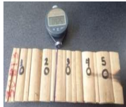
Figura 4. Ensayo de dureza superficial mediante durómetro Shore D en paneles de caña guadua (puntos de medición establecidos en la muestra, conforme a ISO 868).
