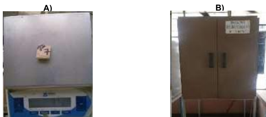
Figura 2. Procedimiento para la determinación del contenido de humedad: (A) pesaje inicial de la muestra en balanza electrónica; (B) secado en horno y pesaje final, conforme a los lineamientos de las normas NTC 5525 y UNE ISO 22157.
