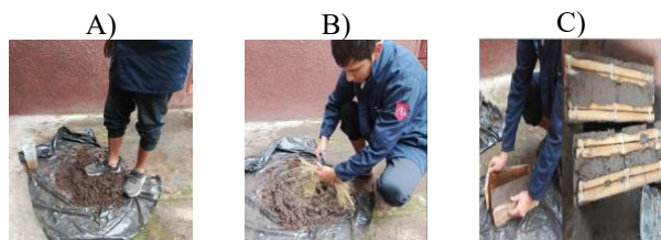
Figura 3. Proceso de elaboración de probetas de bahareque: (A) preparación del barro; (B) adición de paja a la mezcla; (C) elaboración de la probeta.
