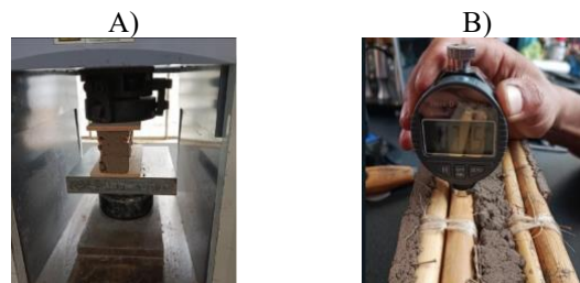
Figura 5. Ensayos mecánicos para la caracterización del bahareque: (A) ensayo de compresión; (B) medición de dureza superficial.
