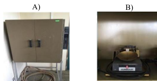
Figura 1. Equipos utilizados para la caracterización del suelo: (A) horno eléctrico; (B) aparato de Casagrande.
