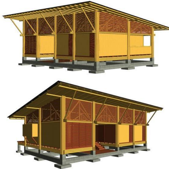
Figura 1: Modelo 1, vivienda Convento. Proceso constructivo, estructura de caña guadua, envolvente de madera y caña rolliza.
