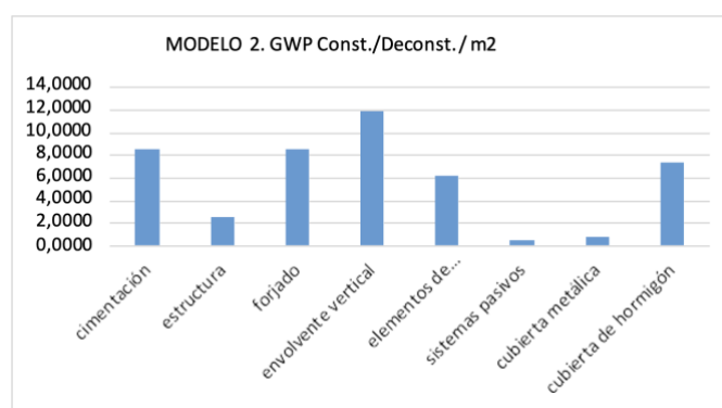
Figura 12: Cálculo del ACV, resultados GWP en fase de construcción/deconstrucción, Modelo 2
