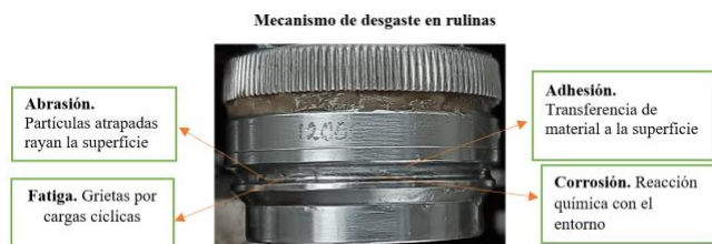
Figura 3: En la Ilustración de la rulina se aprecia los diferentes tipos de desgaste. Fuente: elaboración propia.
