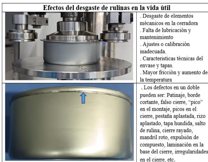
Figura 4: En la ilustración muestra defecto por exceso de presión de rulinas, Incorrecta altura de ajuste de cerrado. Fuente elaboración propia.
