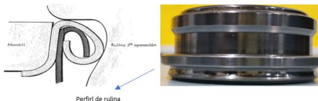
Figura 2: Ilustración de rulina de segunda operación. Fuente: Mundo latas (2019). Recuperado el 28 de mayo de 2025 de https://mundolatas.com/elementos-del-cierre
