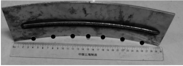
Figura 9: Deformación de placa delgada experimental después de soldar. Feng et al., (2021)
